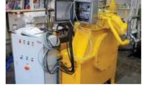
**◀ جهاز التدوير (Turning Gear) لتوربين الغاز MGT-75**
